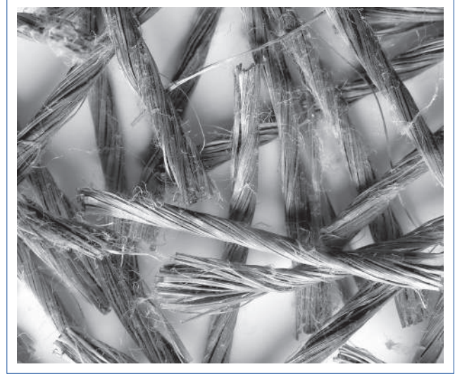
Şekil 1. Kıvrık Geometriye Sahip Polytwist PT54
